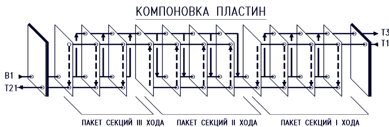
Рис.8. Трехходовой теплообменник T1.PC-0,2. Трехходовые теплообменники для блока горячего водоснабжения T1.PC-0,2
